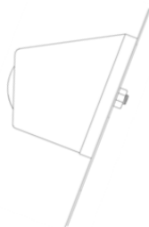
Camera bevestigd op een oppervlak onder een hoek
