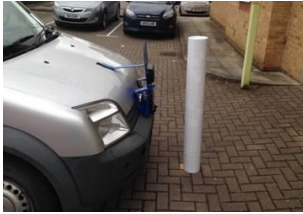
1 m lange paal voor een camera die op 0,6 m hoogte is bevestigd
